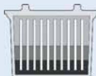
BEZ CARBON BOOST® Kyselina sírová klesne ke dnu článku baterie
